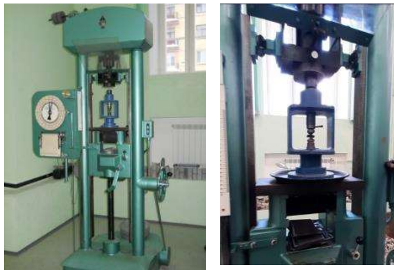
Рисунок 4.3 – Электромеханическая универсальная испытательная машина ЦДМ 2,5 (Германия)
