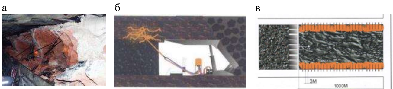
Рисунок 2.8 – Укрепление угольного массива химической смесью в лаве [78]:
