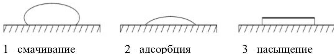
Рисунок 3.5 – Процессы смачивания угольной массы
