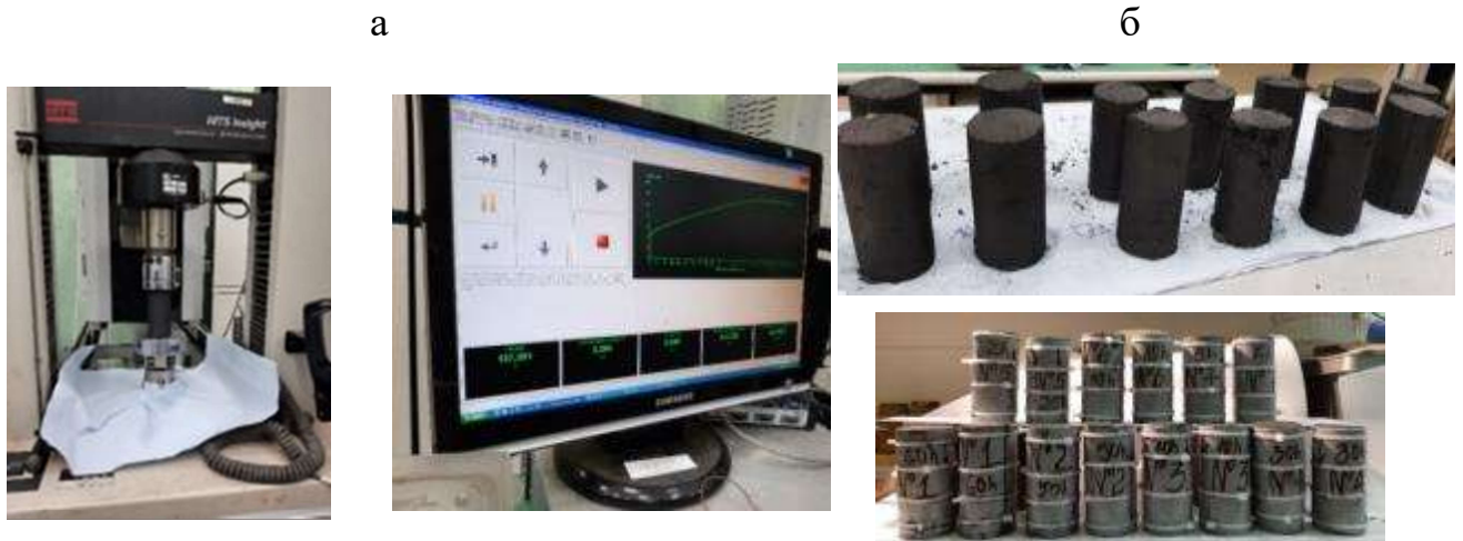
Рисунок 4.12 – Испытательная машина и пробы угля влажностью 15%
