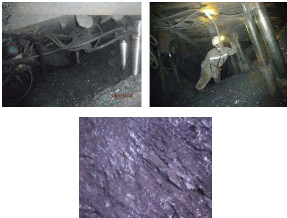
Рисунок 1.6 – Самопроизвольное обрушение угля из кровли и высыпание из забоя лавы
