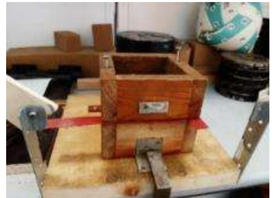
Рисунок 4.4 – Устройство для определения величины силы сцепления угля: N – сжимающая сила; T – сдвигающая сила; A площадь поперечного сечения образца
