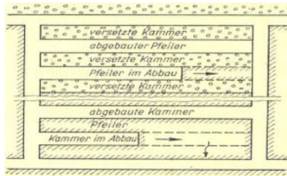
Рис. 1 Камерно-столбовая система разработки с ленточными целиками и закладкой для горизонтальных месторождений малой и средней мощности [Roschlau; Heintze, 1980]
