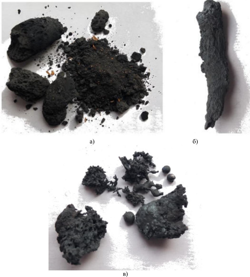
Рисунок 1 – Образцы, полученные при восстановлении гематитовой руды
