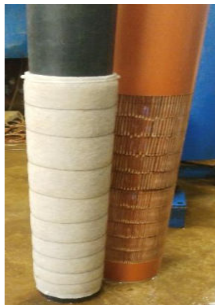
Рисунок 4 –Общий вид сменного фильтрового картриджа ( d125 мм) и щелевого фильтра ( d160 мм)
