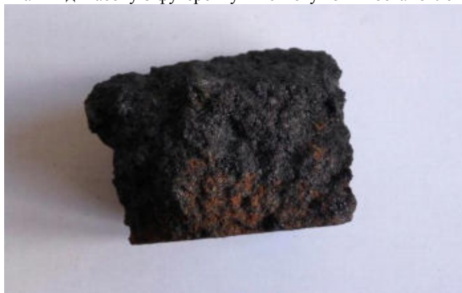
Рисунок 2 - Образец опытного спекания 10% колошниковой пыли и 90% угольной смеси в коксовой батарее Алчевского коксо-химического завода
