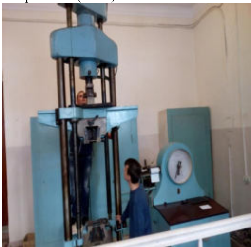
Рис.1 Испытание бетонных кубов на испытательной машине ГМС-50
