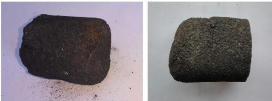
Рисунок 1 – Образцы, полученные при спекании смеси углей и колошниковой пыли в условиях лаборатории каф. МЧМ ДонГТУ
