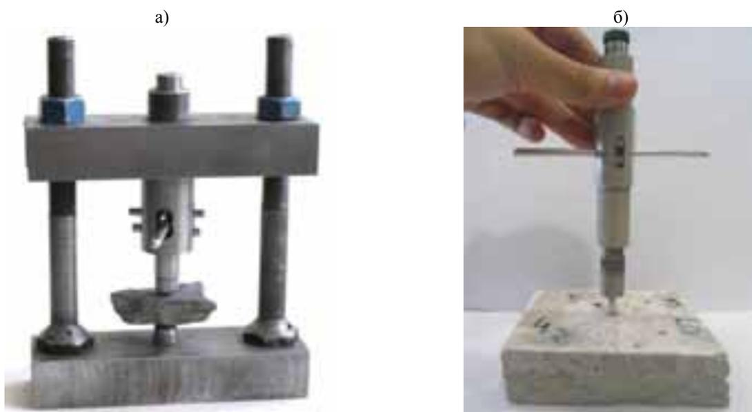
Рис. 3. Прибор для ударно-статических испытаний пород: а) с силовой рамой;
