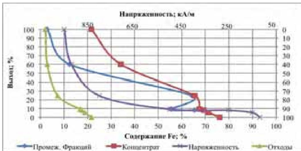
Рис. 2. Кривые обогатимости шлака комплексного состава
