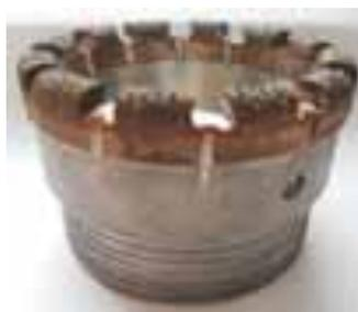
Рис. 3. Опытный образец коронки БСО-1
