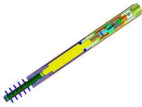
Рис. 2 – 3D-модель гидроударного генератора переменных давлений.
