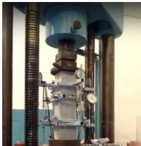
Рисунок 1 – Общий вид установки датчиков перемещений на основе эффекта Холла
