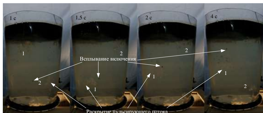
Рисунок 4 – Характер поведения жидкости и неметаллических включений при пульсирующей схеме продувки через 1 с, 1,5 с, 2 с и 4 с от начала опыта
