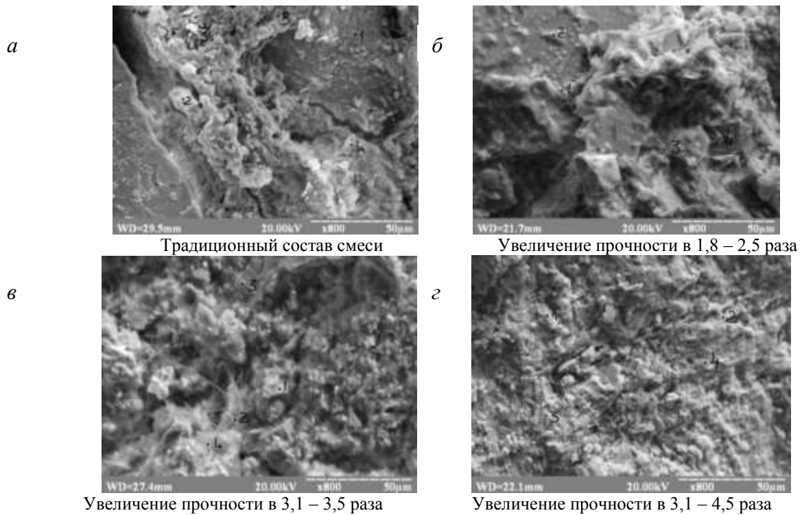
Рис. 1. Изменение структурных связей в твердеющей закладке в зависимости от удельной поверхности частиц шлака и известняка: а – гелеобразная структура (при S_{y0} = 2000 \text{ см}^2/\text{г} ); б – крупноигольчатая структура ( S_{y0} = 2800 \text{ см}^2/\text{г} ); в – игольчатая структура (при S_{y0} = 4300 \text{ см}^2/\text{г} ); г – слоисто-пластинчатая ( S_{y0} = 6600 \text{ см}^2/\text{г} )
