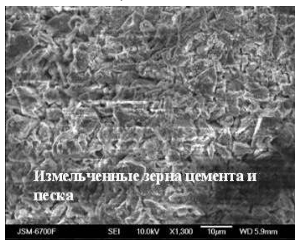
Рис. 4. Электронная микроскопия образцов с измельченными компонентами цемент и песок), ×1300-кратное увеличение
