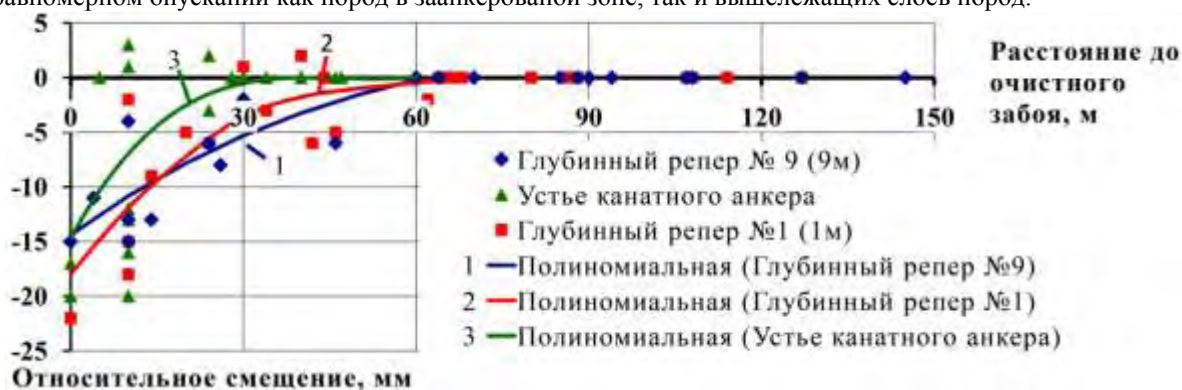
Рис. 1. Зависимости смещений устья канатных анкеров и глубинных реперов от расстояния до движущегося забоя
