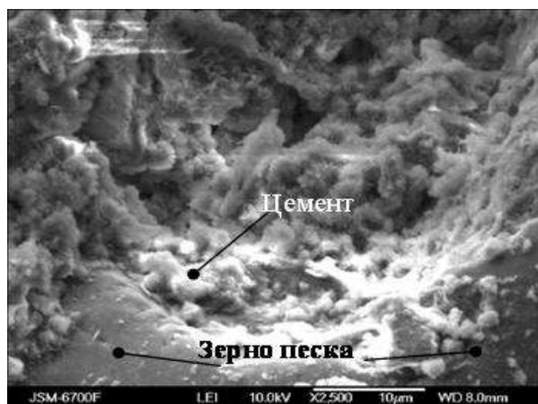
Рис. 2. Электронная микроскопия образцов на стандартных цементе и песке, ×2500-кратное увеличение
