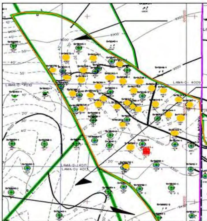
Рис. 2. Схема расположения уплотняющей сетки скважин на Блоке IX
