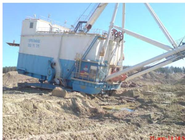
Рис. 3. Предельный крен шагающего экскаватора в результате неравномерной деформации влажной породы в весенний период
