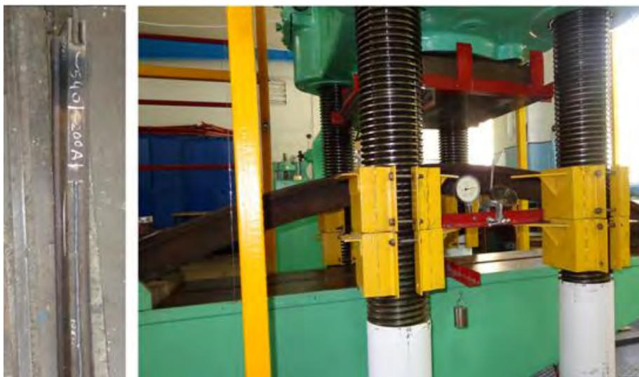
Рис. 2. Вид верхняка с преднапрягающим сварным швом на днище профиля СВП (слева) и фрагмент испытаний на стенде ИПС-500 (справа)
