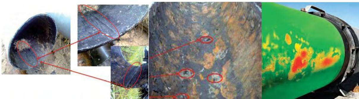
Рис. 1. Последствия неблагоприятного воздействия метана на газопроводы
