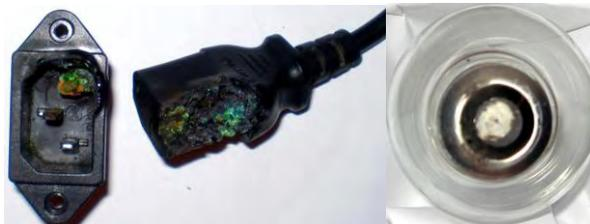
Рис. 4. Старение контактного соединения: в вилке МФУ; в патроне ЛН
