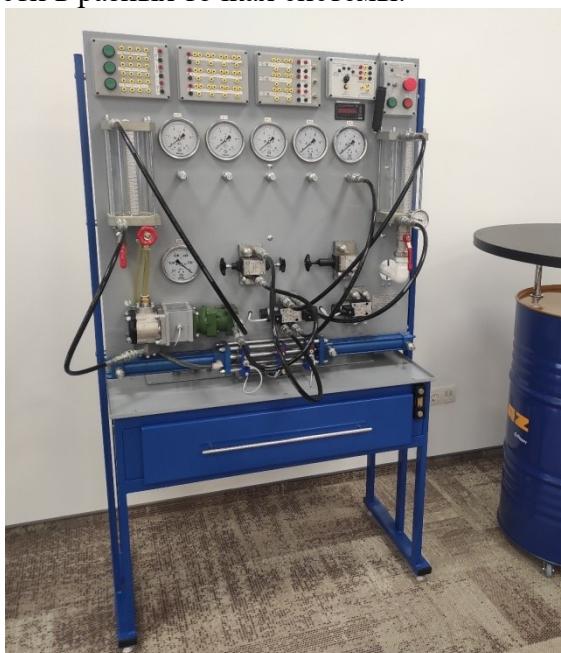
Стенд «Электрогидравлические приводы и автоматика»
