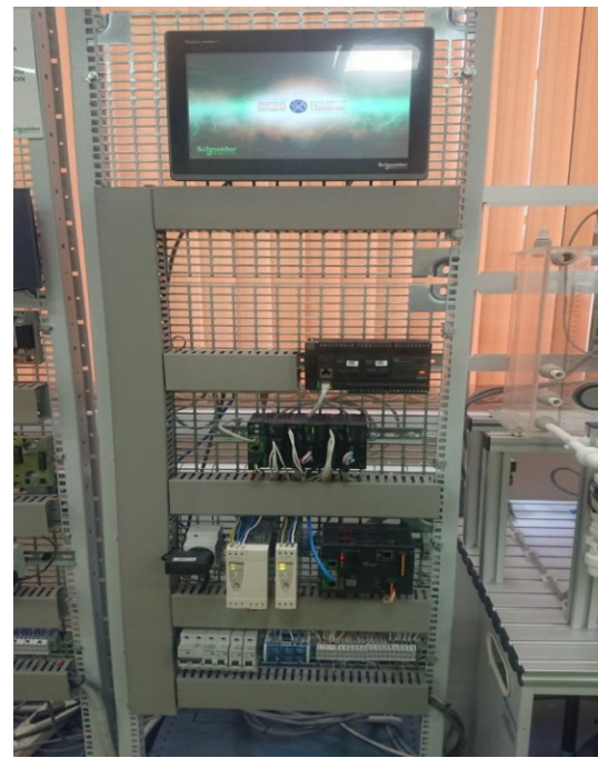
Учебно-тренажерный комплекс – Система управления взрывобезопасным автоматизированным конвейерным транспортом с архитектурой Modicon M580, обеспечивающим
