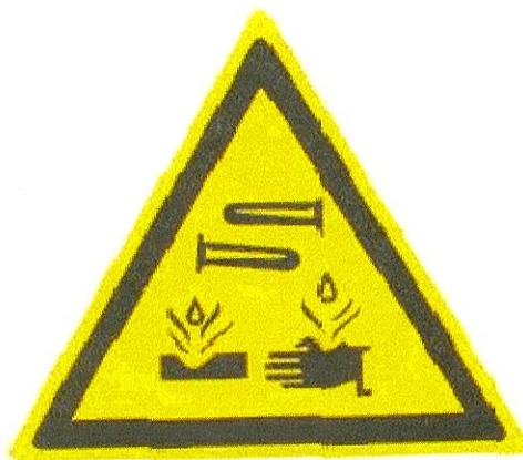
Рис.2 Знак «Опасно! Едкие и коррозионные вещества»
