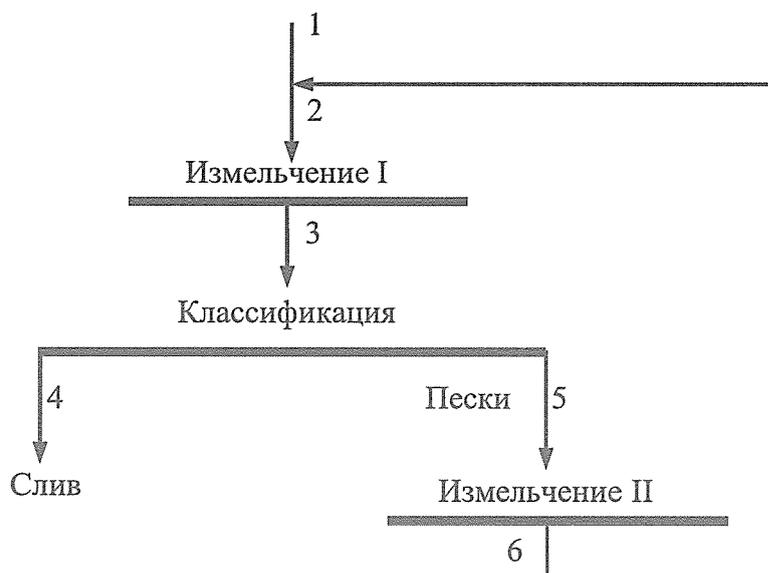
Рис. 6.2 Двухстадийная схема измельчения
