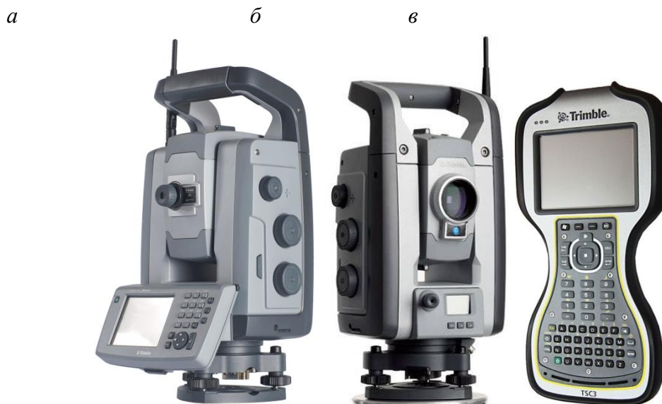
Рис. 1. Внешний вид электронного тахеометра TrimbleVX/S8: а – случай установки контроллера на тахеометр; б – случай работы с тахеометром в режиме robotic; в – контроллер
