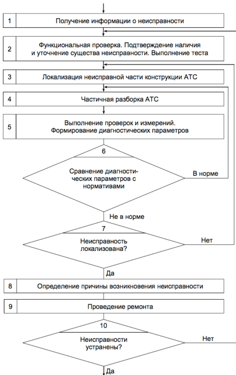
Рис. 2. Условный алгоритм последовательного поиска и устранения неисправностей АТС
