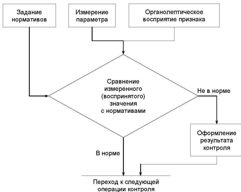
Рис. 1. Алгоритм единичной операции допускового контроля непосредственно проверяемого параметра (признака)
