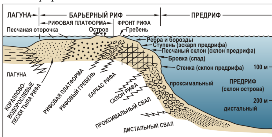
Рис. 3. Схематический разрез, иллюстрирующий различные морфологические элементы на обращенной к морю стороне краевого рифа
