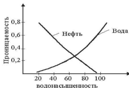
Рисунок 1.2 Изменение относительной проницаемости образца в зависимости от его водонасыщенности
