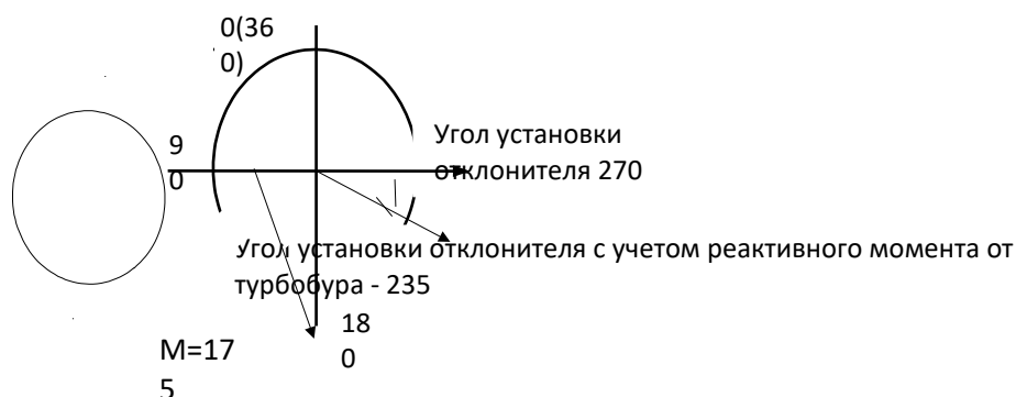
Рис. 2.18. Пример определения величины угла поворота отклоняющего устройства.
