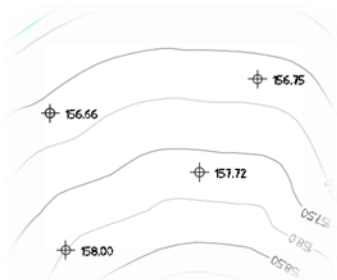
Рис. 22. Результат добавления отметок в точках поверхности
