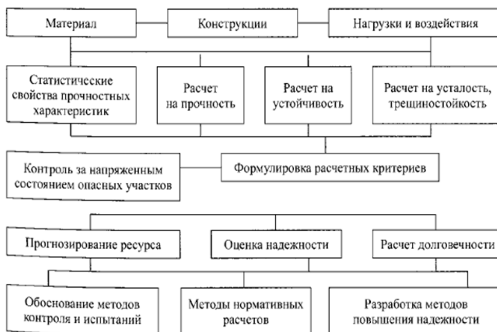
Рис. 2. Структурная схема надежности газопроводов
