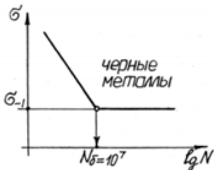
Рис. 10. Схема к определению предела выносливости
