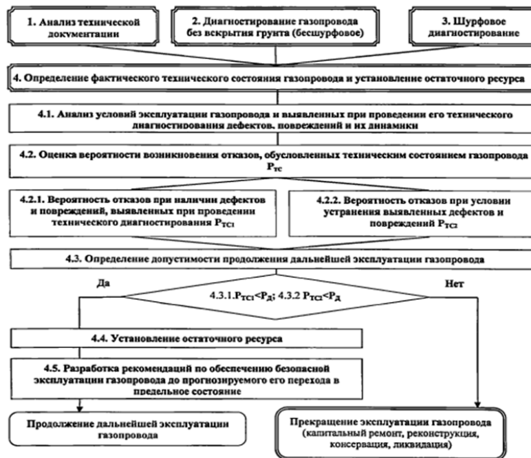
Рис. 13. Схема определения фактического технического состояния
