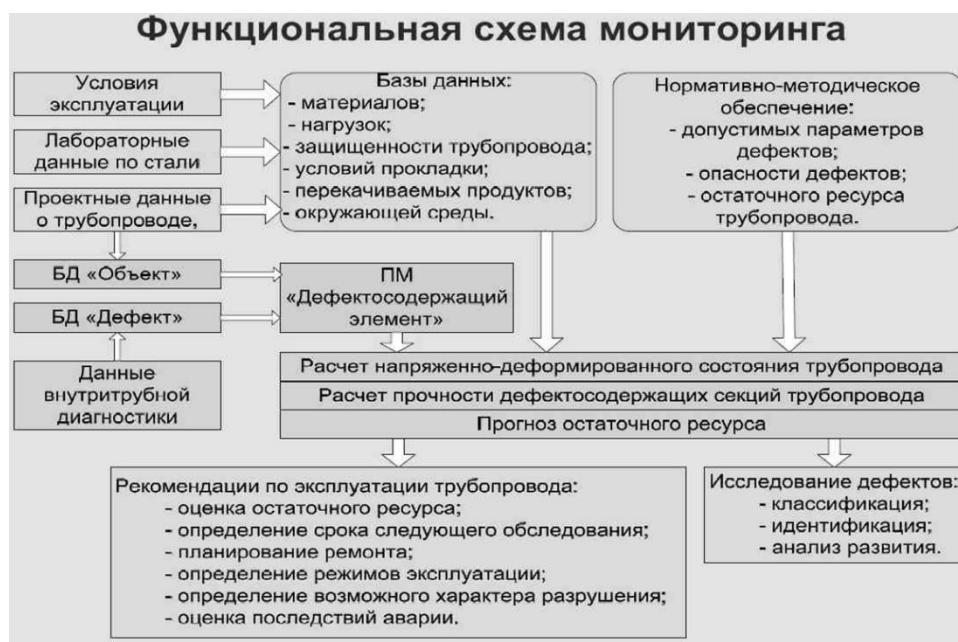
Рис. 17. Функциональная схема мониторинга нефтегазового оборудования.
