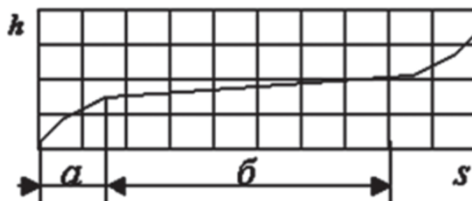
Рис. 12. Интенсивность износа на стадиях: а - приработки; б - нормальной работы
