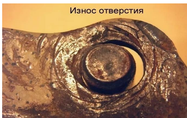
Рис. 11. Фото изношенного отверстия (подшипника)
