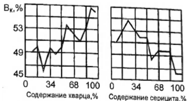
Рис.2.1. Зависимость выхода керна минералогического состава породы
