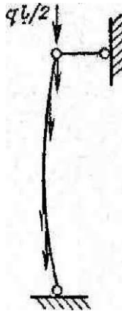
Рис. 35. Возникновение продольного изгиба в сжатой части КБТ при отсутствии вращения
