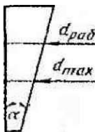
Рис. 60. Схема определения дополнительной деформации пружины при открытии патрона
