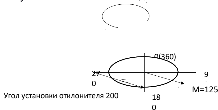
Рис. 2.30. Пример определения угла установки отклонителя.
