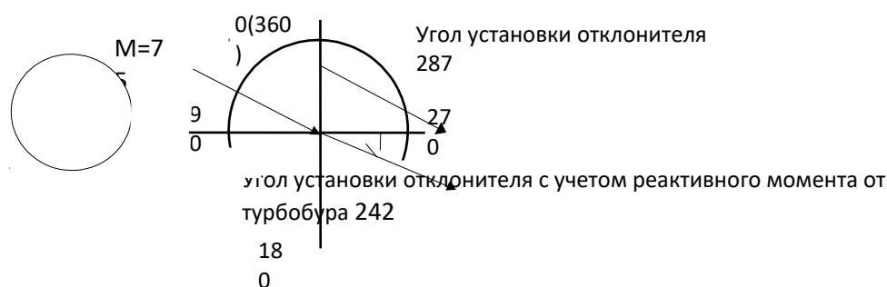
Рис. 2.17. Пример определения величины угла поворота отклоняющего устройства
