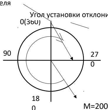
Рис. 2.15. Пример определения величины угла поворота отклоняющего устройства.
