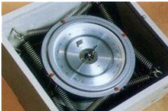
Рис. 4 Барометр-анероид
