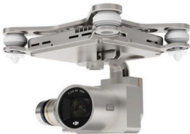
Рисунок 1.10 – Вид камеры, установленной на БЛН Фантом 3
