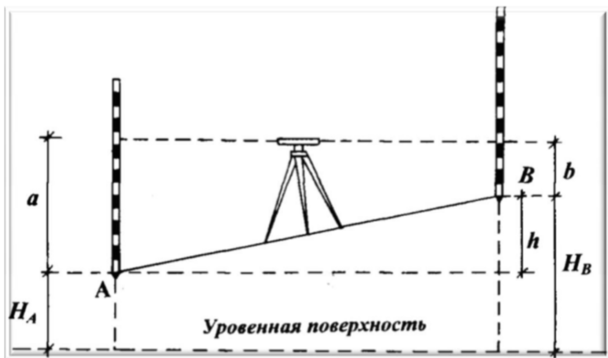
Рисунок 1.8 – Схема геометрического нивелирования из середины Превышение между точками А и В определяем из выражения: (а и b – отчеты по рейке).
