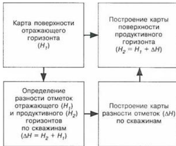
Рис. 5. Схема уточнения структурной карты кровли пласта методом схождения
