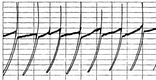
Рис.34. Уменьшение мощности, связанное с превышением скорости углубки над скоростью подачи шпинделя
