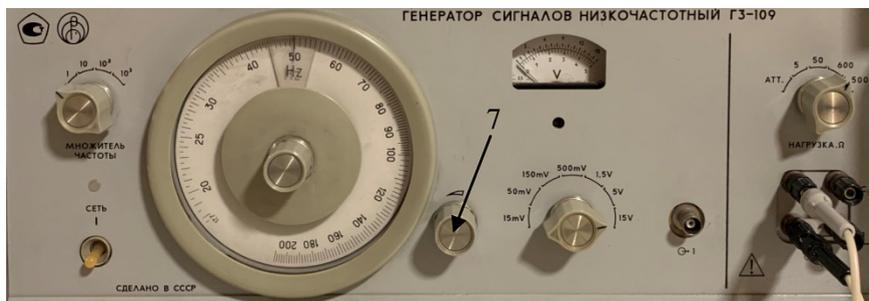
Рис. 15. Генератор сигналов ГЗ-109 (источник переменного напряжения)
