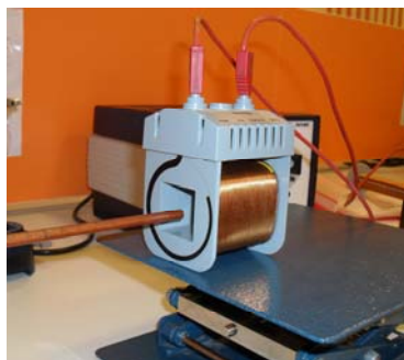
Рис. 14. Внешний вид короткой катушки
