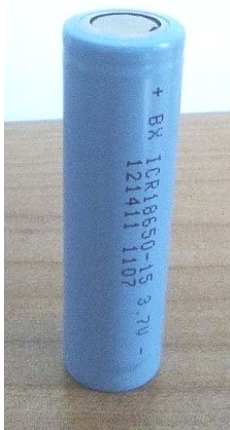
Рис. 5. Литий-ионный аккумулятор форм-фактора 18650
