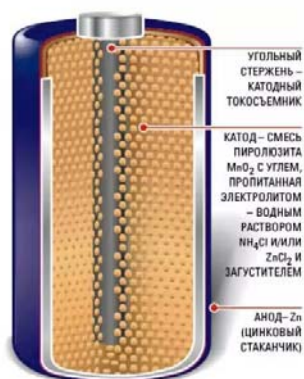
Рис. 3. Устройство гальванического элемента
