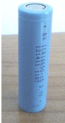
Рис. 5. Литий-ионный аккумулятор форм-фактора 18650
