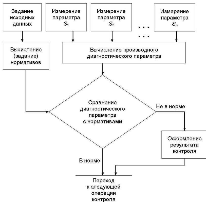
Рис. 2. Алгоритм единичной операции допускового контроля параметра, вычисленного по показателям непосредственно измеряемых параметров
