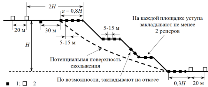
Профильная линия реперов на борту карьера 1 и 2 – репер соответственно рабочий и опорный
