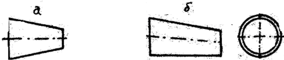
Рис. 18. Переходы: а- концентрический бесшовный; б- эксцентрический штамповварной
