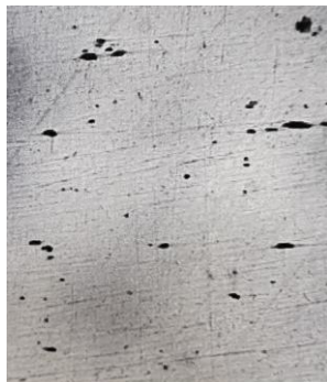
Рис.2. – Микроструктура стали с неметаллическими включениями.
