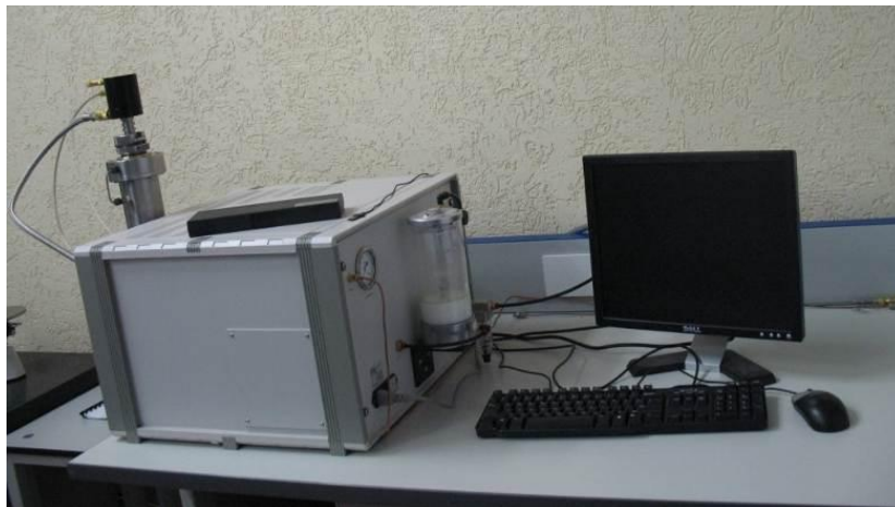
Рисунок 38 – Автоматизированный прибор для измерения пористости, порового объема и проницаемости по газу AP-608
