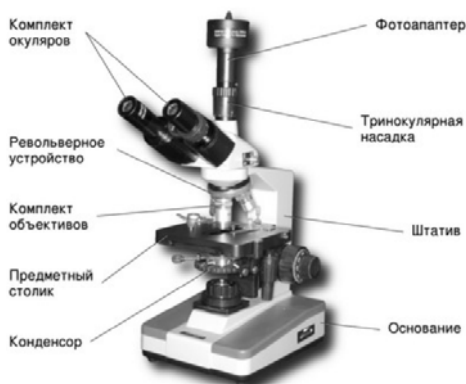
Рис. 2. Бинокулярный микроскоп БИОМЕД-4
