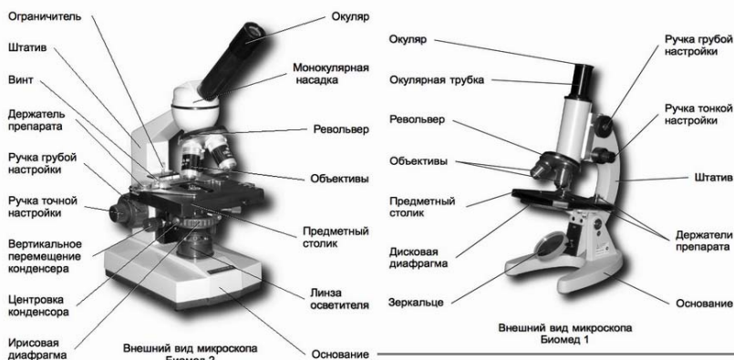
Рис. 1. Внешний вид микроскопов БИОМЕД-1 и БИОМЕД-2
