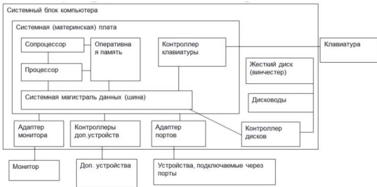
Рис. 11. Схема устройства компьютера
