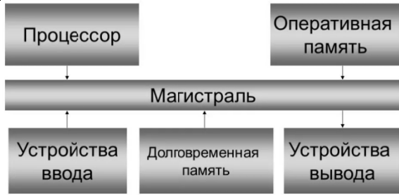
Рис. 15. Схема устройства компьютера
