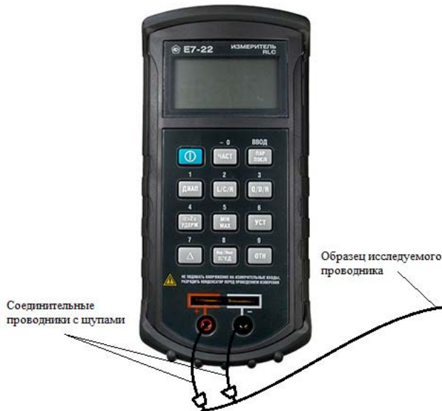
Рис. 9. Измерение сопротивления проводника RLC -метром
