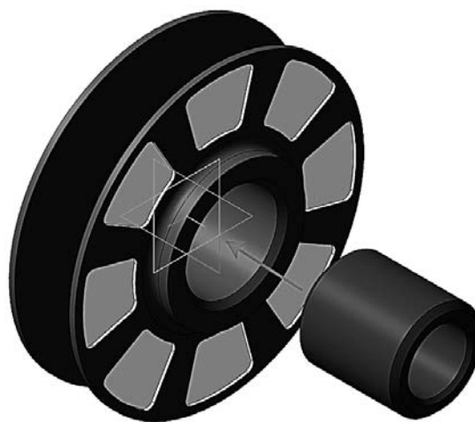
Рис. 17. Соосность «Втулки» и «Ролика»
