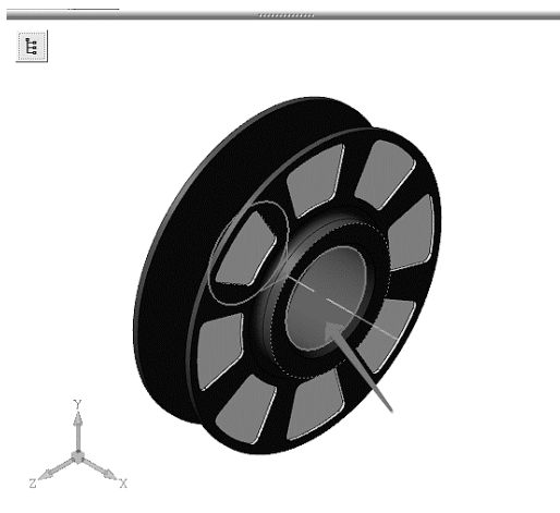
Рис. 25. Указание элемента соосности в сборочной единице «Ролик»
