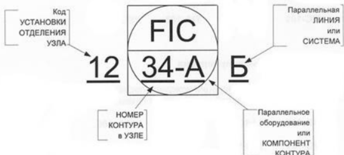
Рис. 3.1 Пример кодирования функций по стандарту ANSI/ISA-5.1-2009
