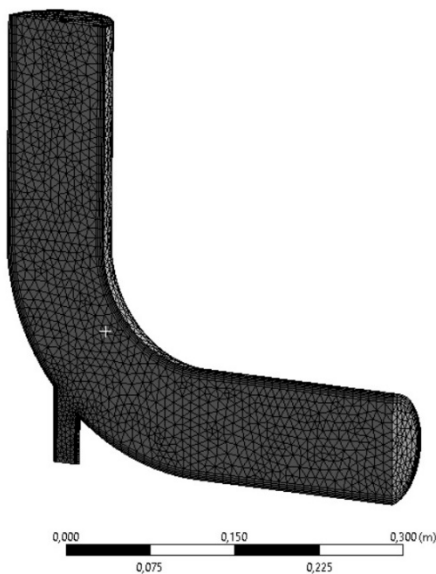
Рис. 7 Вычислительная сетка для геометрии патрубков в ANSYS Meshing
