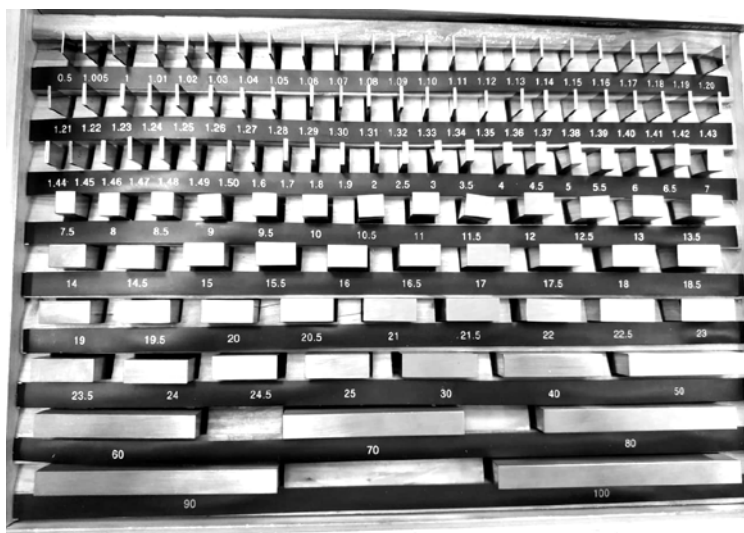
Рис. 2. Набор плоскопараллельных концевых мер длины, используемый для выполнения лабораторной работы
