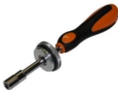
Рис. 13. Специальный крючок для настройки предохранительного сбросного клапана
