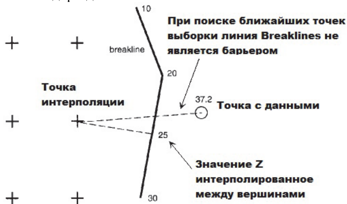
Рис. 7. Линии типа Breaklines
