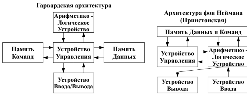
Рис. 2. Гарвардская и Принстонская архитектуры ЭВМ.
