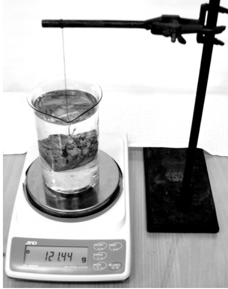
Рис. 2.1. Метод обратного гидростатического взвешивания
