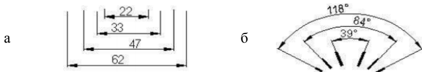
Рис.6 Нанесение параллельных и концентрических размеров
