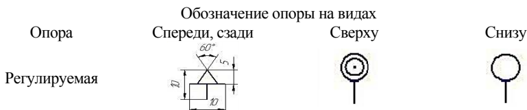
Рис.18 Вид и условное обозначение регулируемых опор
