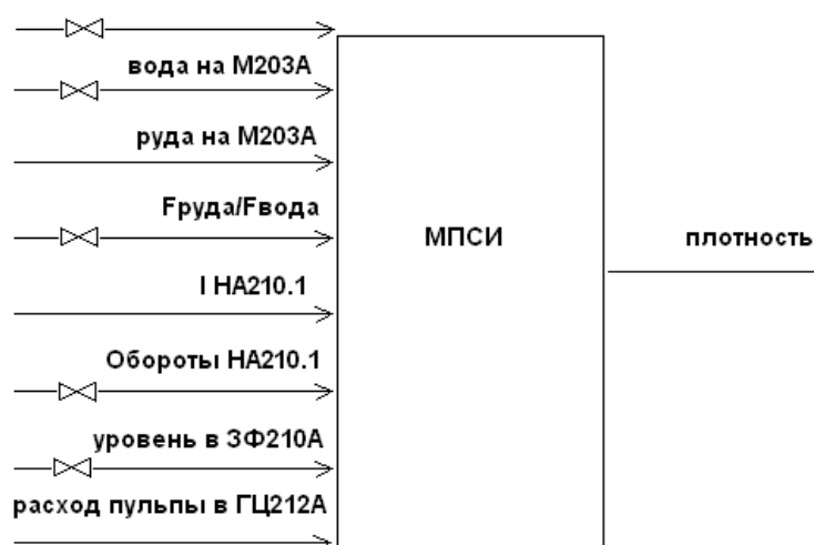
Рис. 22. Входные и выходные параметры, используемые при построении модели, стабилизирующей плотность выходной пульпы с ГЦ в секции ПСИ
