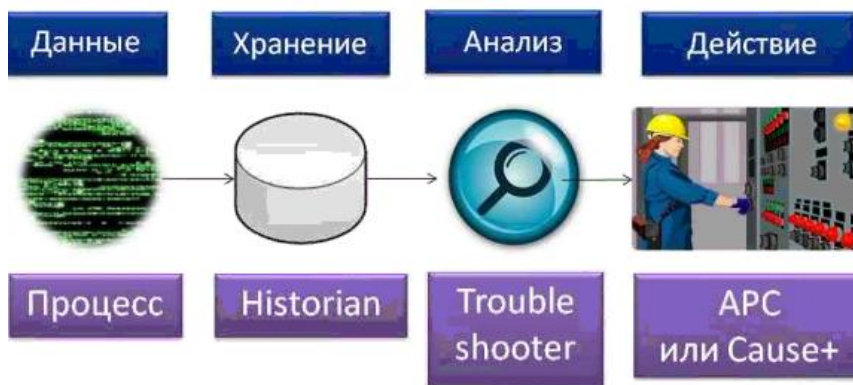
Рис. 4. Схематичное отображение стадий анализа и совершенствования технологических процессов
