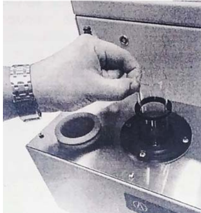
Рис. 8 – Установка испытательного сосуда в охлаждающую баню
