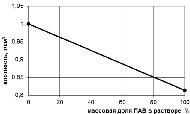
Рис. 3. Определение плотности раствора ПАВ (на примере амилового спирта)
