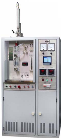
Рис. 1а Установка разгонки нефтепродуктов 1 - АРН-2 и 2 - АРН-3
