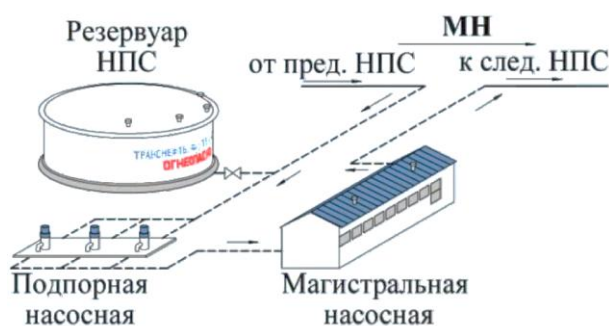
Рис. 8 Схема перекачки «с подключенным резервуаром».
